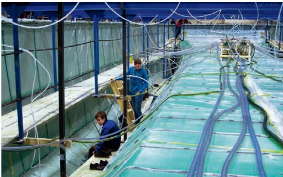
Подача смолы для пропитки сухой ткани и пенопласта
