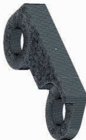
Расчетная модель шарнирной рамы для испытания на сдвиг в плоскости слоев
